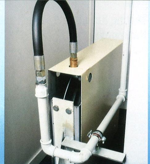
Die Ölabgabe erfolgt über einen integrierten Schlauchaufroller und eine Automatikzapfpistole mit Mengenanzeige.
